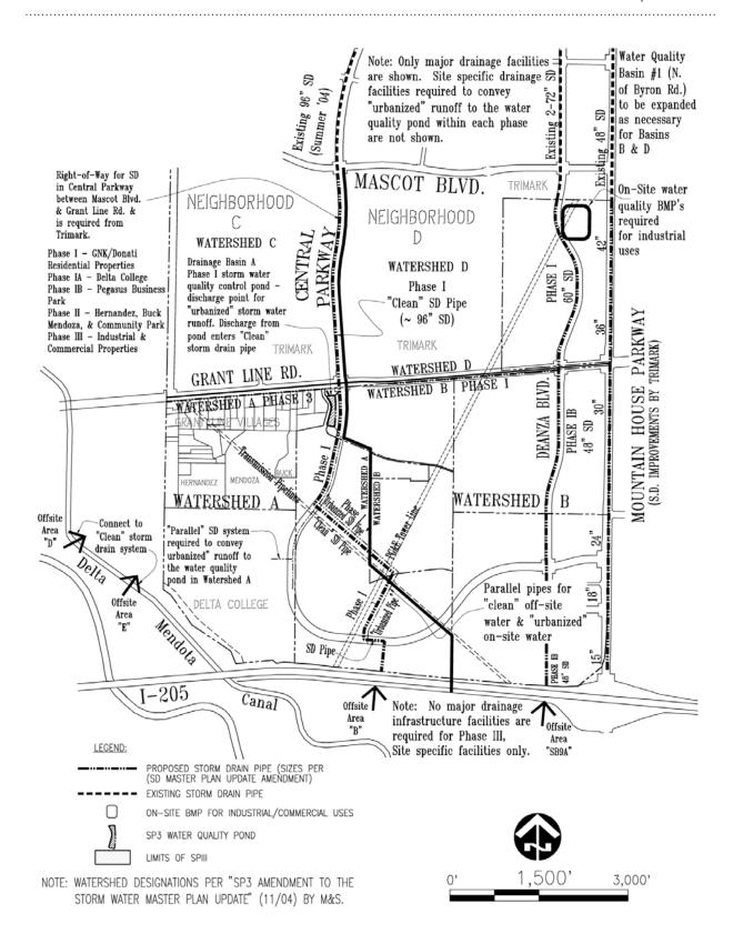
FIGURE 15-1: STORM DRAIN TRUNK SYSTEM
